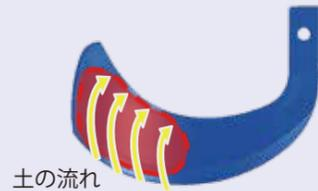
青い爪は、爪取付部から緩やかにカーブし、先端は広幅で大きな曲線で形成されており、プラウ(鋤)に似た刃体構造となっています。
